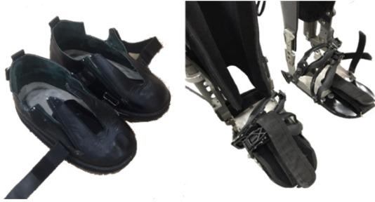
그림 1. 워크온 슈트의 발 모듈, 왼쪽부터 인솔 타입 모듈의 신발, 아웃솔 타입 모듈.
