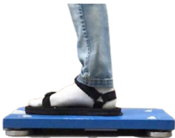
그림 7. 힘판을 이용한 보행 중 실험 과정. Fig. 7. Experiment setting with force plate for walking.
